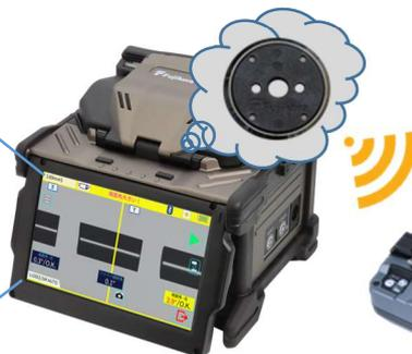
切断刃の摩耗を検知
